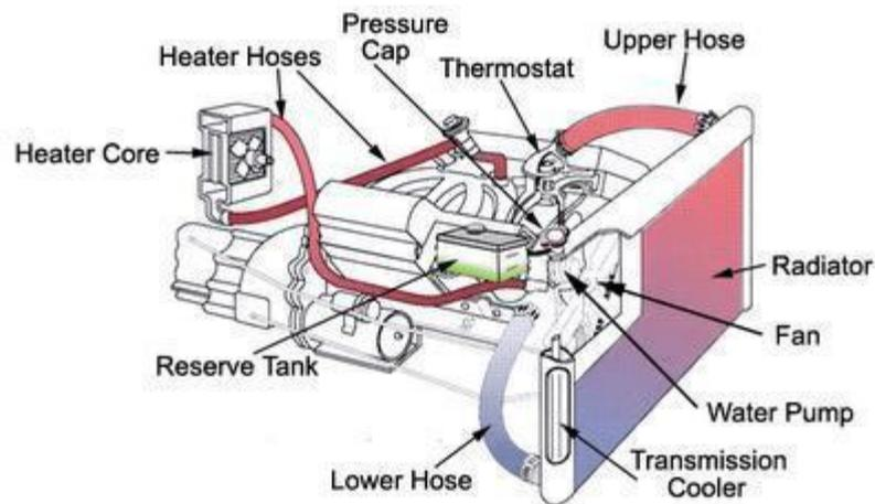
Fig: Liquid Cooling System
