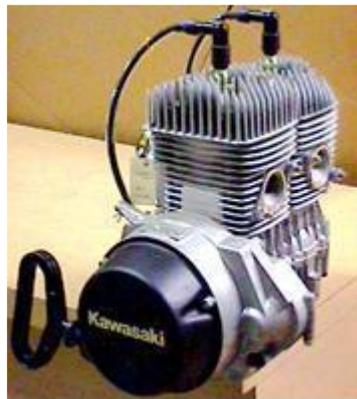
**Fig: Air Cooling System**
